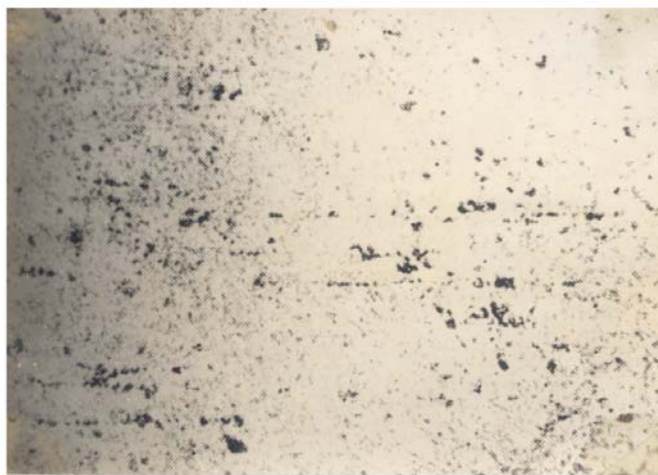
Hình 10.3-Tổ chức tế vi của đura sau nhiệt luyện
